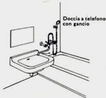
⑥ Gruppo miscelatore comune per lavabo e bagno con doccia.
