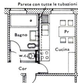
⑧ Tipo di cucina standard americana. Tutte le condutture per la cucina e il bagno, su parete divisoria smontabile.
